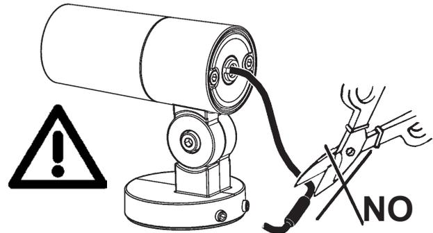
IT Cablare alla rete elettrica il trasformatore solo dopo aver effettuato il collegamento ai prodotti
