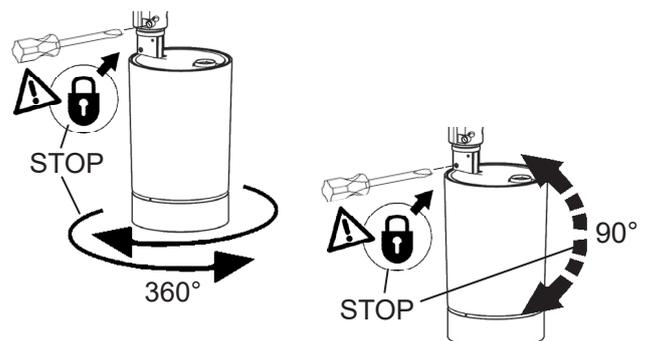
regolazione dell'intensita' luminosa - adjusting the luminosity
