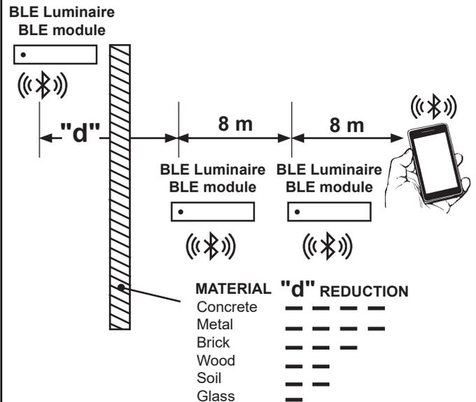
**IT** La distanza massima dipende anche dalla disposizione nello spazio e dalla presenza di altri segnali wireless. Si raccomanda di verificare l'affidabilità della comunicazione nella posizione di installazione effettiva mediante un semplice mock-up.
