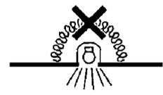
IT N.B.: Apparecchi non idonei ad essere coperti di materiale termicamente isolante
