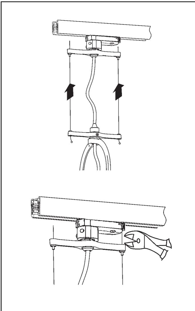
BLOCCO MECCANICO DEL PUNTAMENTO DEL VANO - MECHANICAL LOCKING OF THE ASSEMBLY AIMING SYSTEM - VERROUILLAGE MÉCANIQUE DE L'ORIENTATION DU BLOC OPTIQUE - MECHANISCHE BLOKIERVORRICHTUNG DES LEUCHTENGEHÄUSES
