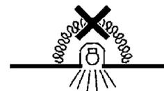
IT N.B.: Apparecchi non idonei ad essere coperti di materiale termicamente isolante
