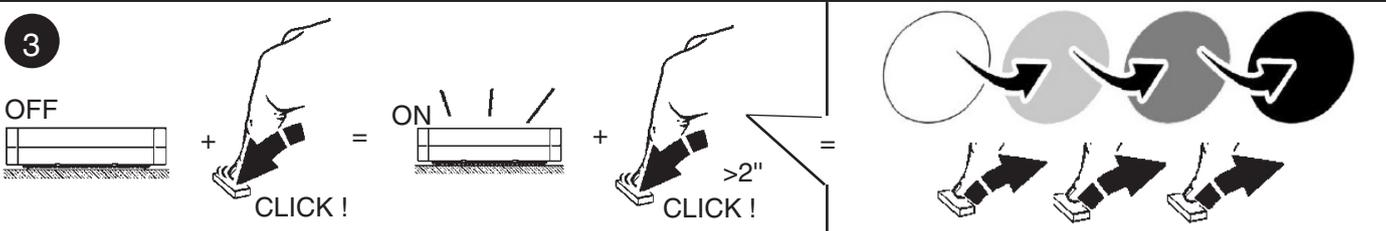
**IT** I dispositivi con cablaggio digitale possono essere dimmerati con dispositivi DALI o con pulsante normalmente chiuso (N.C.) da collegare come da schema.
