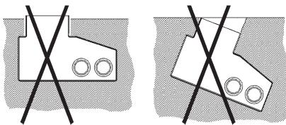
**IT** Il bordo superiore delle controcasse, una volta installate, non deve sporgere dal livello del pavimento o del muro.
