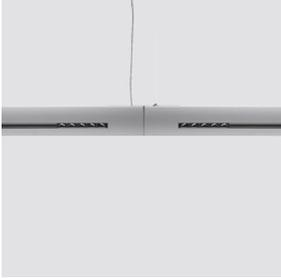
**Référence produit**MJ25: module pour file continue L 1278 - Fort contraste - LED Blanc Neutre - émission up / down - alimentation électronique intégrée - émission down UGR < 19 - émission up diffuse **Attention ! Code abandonné****Description technique**
