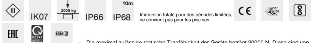
Die maximal zulässige statische Tragfähigkeit der Geräte beträgt 20000 N. Diese sind von Fahrzeugen mit Luftreifen befahrbar. Die Geräte dürfen nicht in Fahrbahnen eingesetzt werden, in denen sie horizontalen Beanspruchungen ausgesetzt sind, die durch Beschleunigung, Abbremsen und/oder Fahrtrichtungswechsel verursacht werden.
