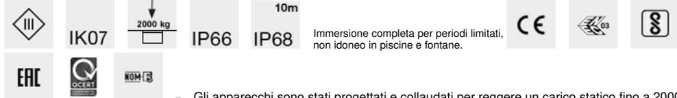
□ Gli apparecchi sono stati progettati e collaudati per reggere un carico statico fino a 20000 N e sono carrabili per autoveicoli con pneumatici. Gli apparecchi non possono essere impiegati in corsie nelle quali sono sottoposti a sollecitazioni orizzontali dovute a accelerazioni, frenate e/o cambi di direzione.
