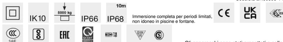
□ Gli apparecchi sono stati progettati e collaudati per reggere un carico statico fino a 50000 N e sono carrabili per autoveicoli con pneumatici. Gli apparecchi non possono essere impiegati in corsie nelle quali sono sottoposti a sollecitazioni orizzontali dovute a accelerazioni, frenate e/o cambi di direzione.
