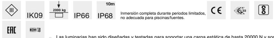
Las luminarias han sido diseñadas y testadas para soportar una carga estática de hasta 20000 N y son ideales para resistir el paso de vehículos con neumáticos. Las luminarias no pueden ser utilizadas en pasajes donde las luminarias se expongan a la tensión horizontal causada por la aceleración, frenado y / o cambios de dirección de los vehículos.
